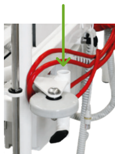
Dropstativholder med fingerskrue.
