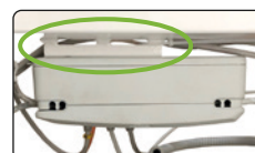
Ledninger ført bag Port-udvidelsesboksen/Fordelerboksen og ophængt med strips.
