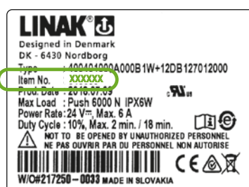
Eksempel på Item-nr. (Item No/Item): Alle elektriske komponenter har et Item-nr. som fremgår af fabriksmærkatet fra LINAK.
