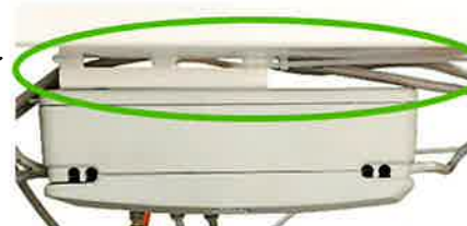
Ledninger ført bag Port-udvidelsesboksen/fordelerboksen og ophængt med strips.
